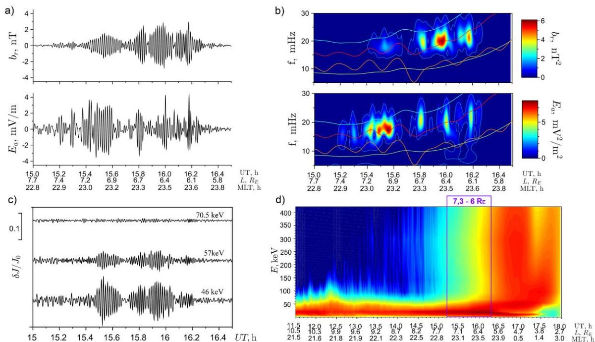
**Рисунок.** По данным спутника ТНД показаны: (а) - колебания радиальной  $b_r$  компоненты магнитного и азимутальной  $E_a$  компоненты электрического поля, (б) - их динамические спектры, цветные линии на спектрах - рассчитанные собственные альфвеновские частоты, (с) – колебания потоков протонов  $\delta I/I_0$  с энергиями от 46 кэВ до 70.5 кэВ, (д) - потоки протонов в диапазоне энергий от 1 до 450 кэВ (7,3-6  $R_E$  – область локализации колебаний).
