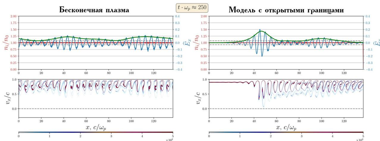
Рис.1. Релаксация электронного пучка с плотностью  $n_b=0.01n_0$  и направленной скоростью  $vb=0.9c$  в плазме с плотностью  $n_0$  в двух моделях. Сверху: Безразмерное электрическое поле  $E_x$  и плотность ионов плазмы. Снизу: фазовый портрет электронов пучка.
