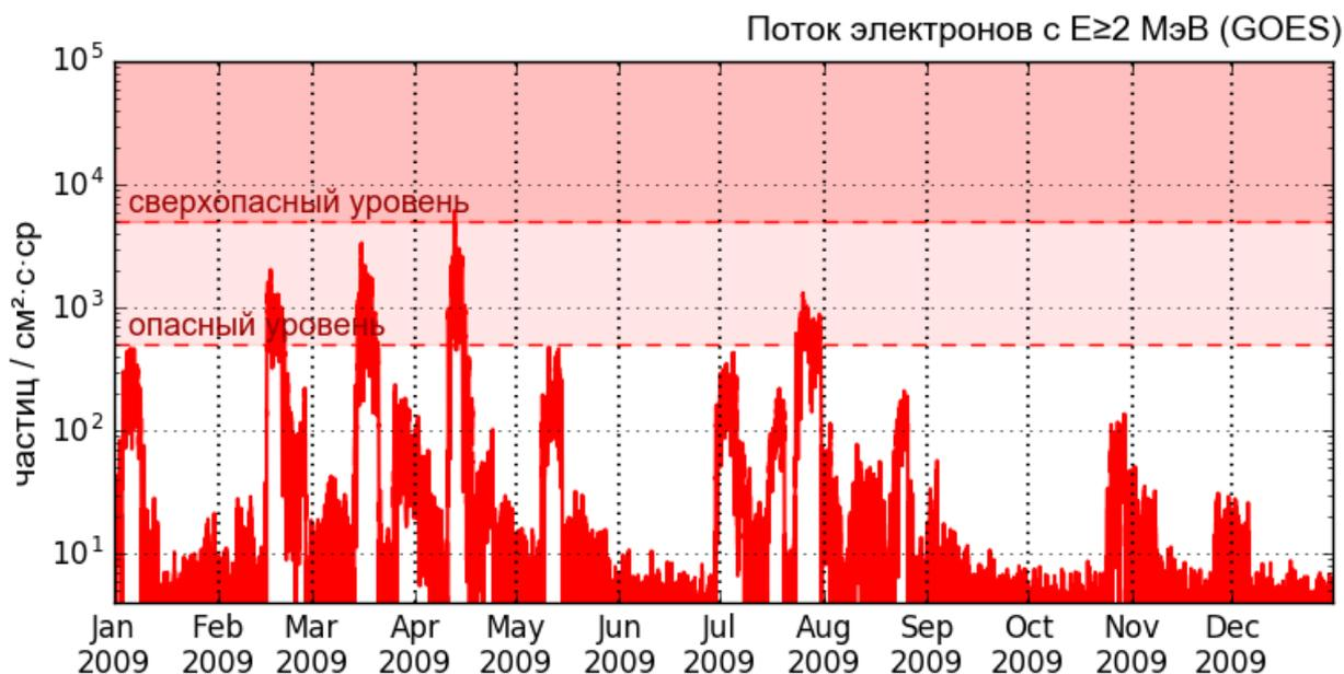
Рис. Поведение потока магнитосферных электронов в 2009 г. по данным спутника GOES.
