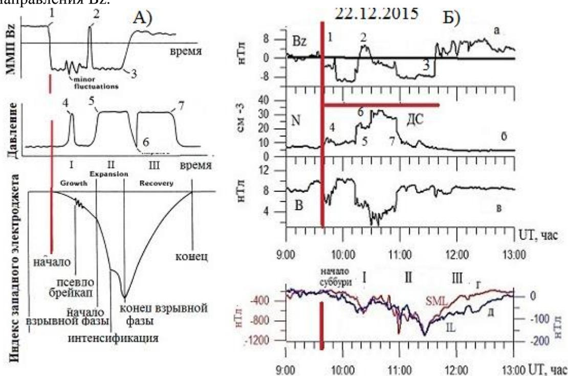
А) Статистическая модель связи между скачками  $B_z$  ММП, давления СВ и вариацией AL индекса магнитной активности в течение изолированной суббури. Цифрами обозначены характерные моменты вариаций. [McPherron R. L., Terasawa T., Nishida A J. Geomag. Solar Wind Triggering of Substorm Expansion Onset. *J. Geomag. Geoelectr.*, 38, 1089-1108, 1986]
