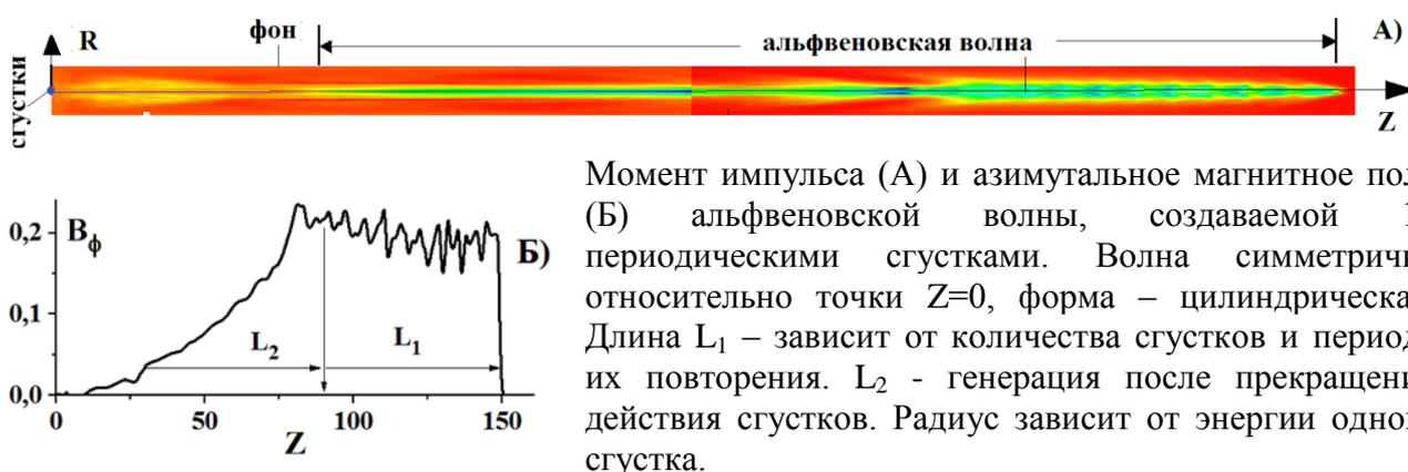
Момент импульса (А) и азимутальное магнитное поле (Б) альфвеновской волны, создаваемой 10 периодическими сгустками. Волна симметрична относительно точки  $Z=0$ , форма – цилиндрическая. Длина  $L_1$  – зависит от количества сгустков и периода их повторения.  $L_2$  - генерация после прекращения действия сгустков. Радиус зависит от энергии одного сгустка.
