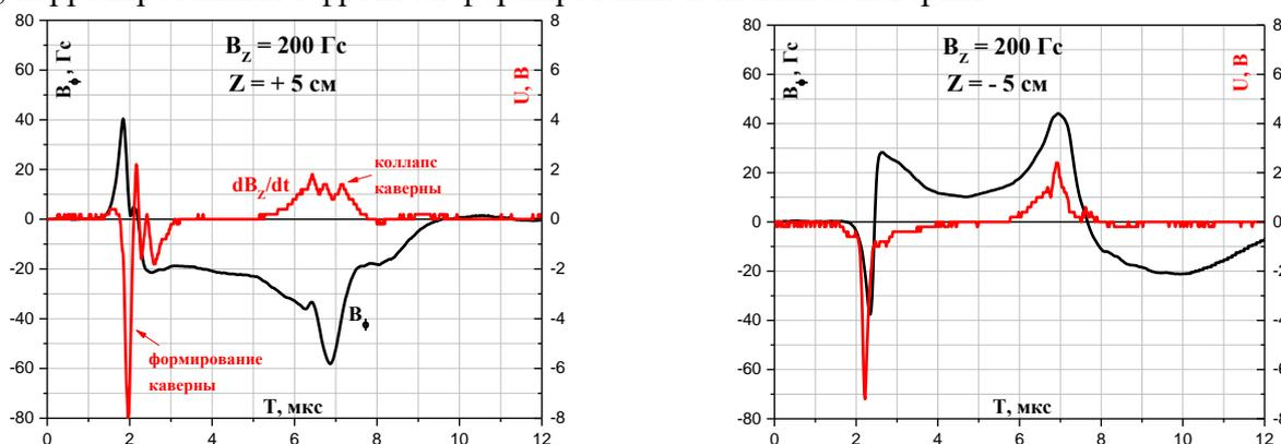
Сигналы магнитных зондов. Красные кривые – производная возмущения основной компоненты, которая показывает формирование каверны (передний фронт) и коллапса каверны (задний фронт). Черные кривые показывают величину азимутальной компоненты. Измерения сделаны при положительных и отрицательных координатах Z относительно экваториальной плоскости при одном поперечном расстоянии от мишени  $X = 5$  см.
