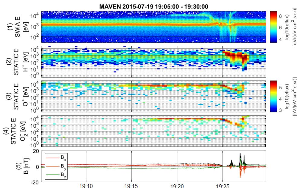
(1) – спектр ионов без разделения масс; (2)–(4) – спектры H<sup>+</sup>, O<sup>+</sup>, O<sub>2</sub><sup>+</sup>;
